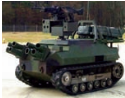
İnsansız yer araçları üzerine eklenen silahlarla birer savaş makinesine dönüşüyor. Bu modele Sword (kılıç) adı veriliyor.
